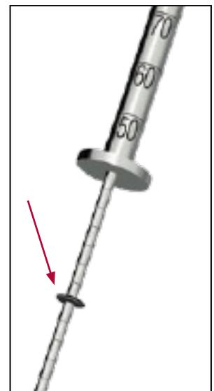
Coloque el anillo de goma al extremo de la funda guía. El orificio se crea perforando hacia adelante y jalando hacia atrás la perforadora, lejos del hueso. La **longitud del orificio** se lee contando las marcas de las líneas láser de 5 mm entre la funda de la guía y el anillo de goma (*en este ejemplo, 35 mm*).
