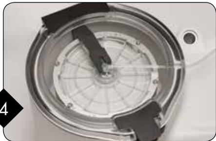
4 Baje el brazo estator de la centrifuga alineándolo con la lengüeta levantada encima de la cámara de separación de volumen variable. Coloque el tubo que se dirige desde la cámara de separación de volumen variable a través de la ranura de los pocillos de la centrifuga. Cierre la tapa de la centrifuga asegurándose que los tubos estén en la ranura y no obstruidos por la tapa.
