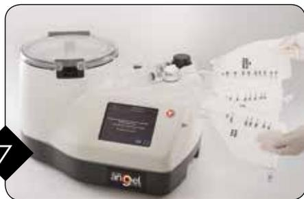
7 *Nota:* es imprescindible que el ensamble de la válvula/cubeta de plaquetas se sienta completamente en la máquina para que se detecten correctamente los componentes sanguíneos.
